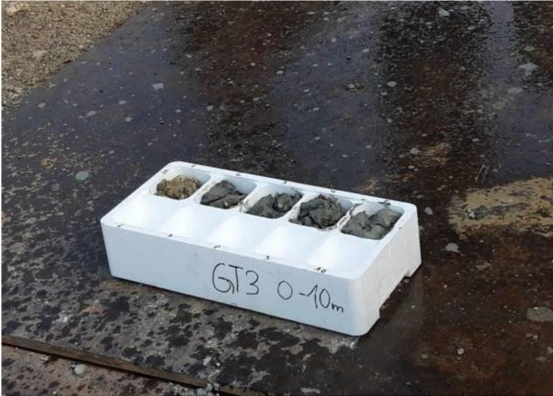
Bodenproben Bohrung GT3 mit Tiefenangabe
